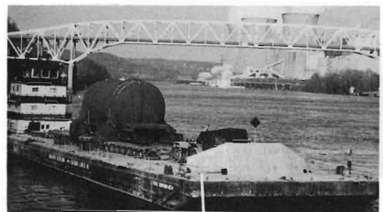
バージでオハイオ川を下る原子炉圧力容器
