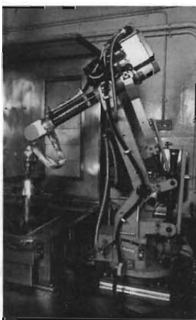
写真2 プラズマ溶断ロボット
